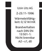
UZIN SC 914 Turbo für die Anwendung als Wärmedämmstoff nach allgemeiner bauaufsichtlicher Zulassung
