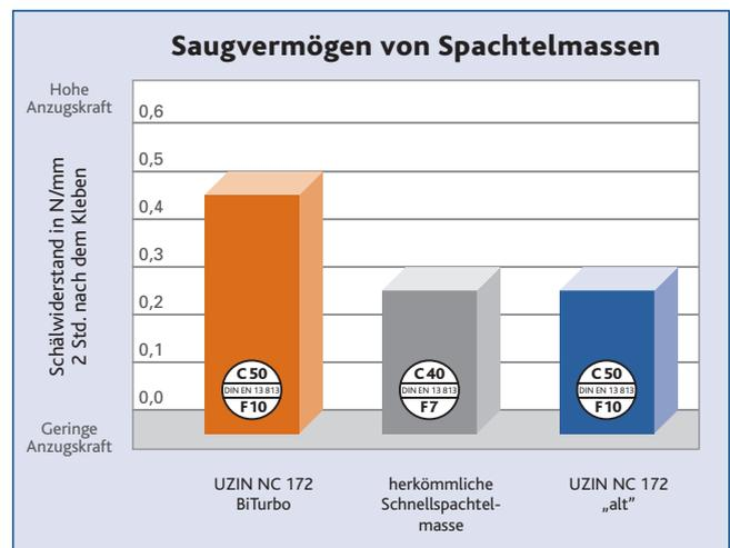
Die Saugfähigkeit von UZIN NC 172 BiTurbo ist in etwa doppelt so hoch wie bei üblichen Schnellspachtelmassen. Die Ablüftezeit des Klebstoffes bei der Verlegung reduziert sich im Vergleich zu üblichen Spachtelmassen immens. Der Handwerker ist beim Verlegen der Oberbeläge deutlich schneller und die Gesamtopik der fertigen Bodenbelagsfläche ist sehr glatt und ruhig.
